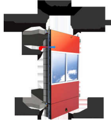
Cấu tạo module tường bằng vật liệu composite nhãn hiệu G-vent
